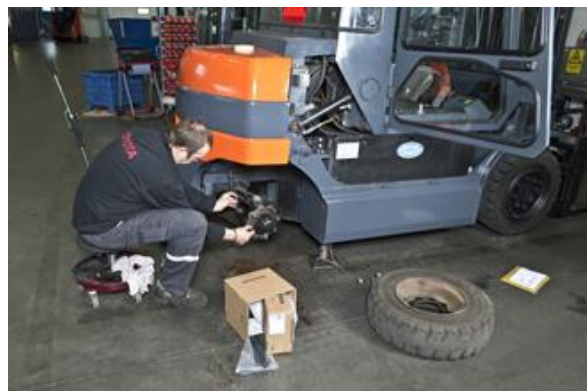
写真: Toyota Material Handling (在スウェーデン・ミョールビー) のフォークリフトのRemanufacturingプロセス(Toyota Material Handlingより許可を得て掲載)
